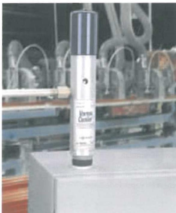
*Şekil 15. Vortex borusu görünümü*
