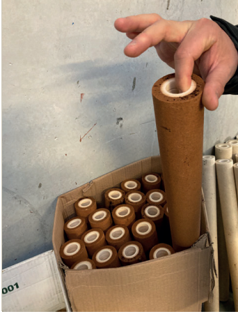
Resim 3. Kuyu Suyundaki Demir ile Tıkanmış Filtre Kartuşu
