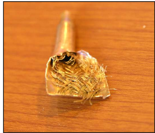
Şekil 4. Isı borularında kullanılan çeşitli fitil yapıları
