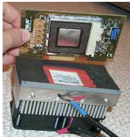
Şekil 4. Peltier devresi kullanarak bilgisayarın işlemcisinin soğutulması [3]
