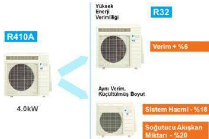
Şekil 7. R32 Kullanımının Enerji Verimliliği ve/veya Sistem Boyutlarına Olan Etkileri
